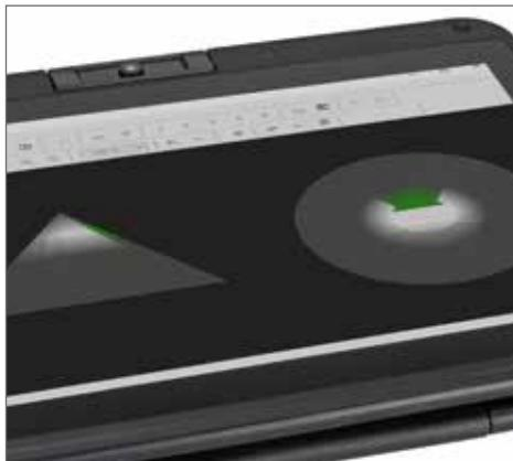
Das Fusion Professional Plus bietet die Spezialfunktion *Live Scan*: Der direkte „Blick“ in den Boden. Mit dieser Echtzeitmessung lassen sich unterirdische Objekte besonders schnell und flexibel lokalisieren. In horizontaler Ausrichtung werden detektierte Strukturen in Echtzeit durch unterschiedliche Farben dargestellt. In vertikaler Ausrichtung werden die Objekte als versinnbildlichtes Ultraschallbild angezeigt.
