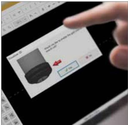
Am Tablet-PC werden mittels Touchscreen zunächst wichtige Parameter für den Messvorgang eingestellt. Während des Scans zeichnet die 3D-Software die Messwerte auf und visualisiert diese zeitgleich als mehrfarbige 3D-Grafiken, um unterirdische Objekte darzustellen.
